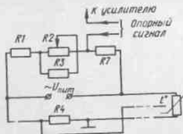
Рис. 50. Схема подключения терморезистора (датчика) к ПТР-3
